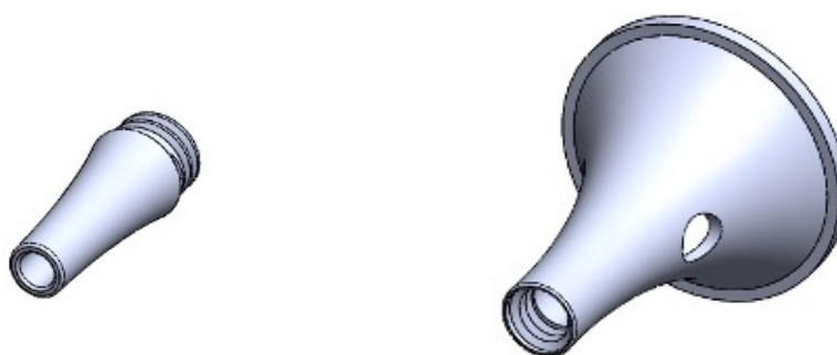
Figura 6 - Cone Focalizador para cadelas médias e pequenas, com opção de rosqueamento de ponteira para adaptação ao tamanho vulvar de cada animal
