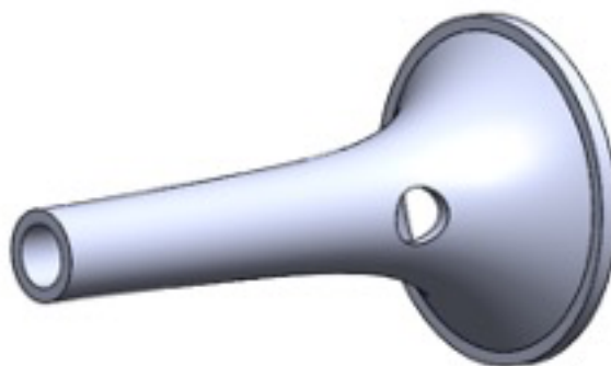
Figura 5 - Cone focalizador para cadelas grandes, com 8 cm de comprimento
