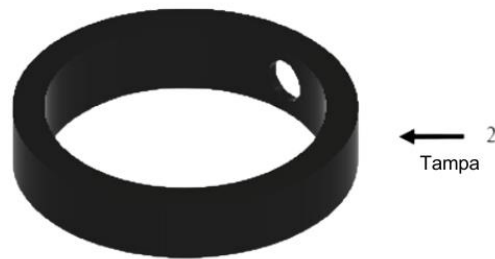
Figura 3: Detalhamento da tampa (com orifício liberador do produto) do corpo principal do recipiente para a cura de umbigo de bezerros neonatos
