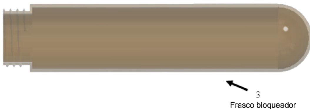
Figura 5: Detalhamento do frasco bloqueador do recipiente para a cura de umbigo de bezerros neonatos
