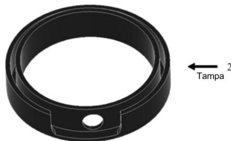
Figura 4: Detalhamento da vista inferior da tampa (com orifício liberador do produto) do corpo principal do recipiente para a cura de umbigo de bezerros neonatos
